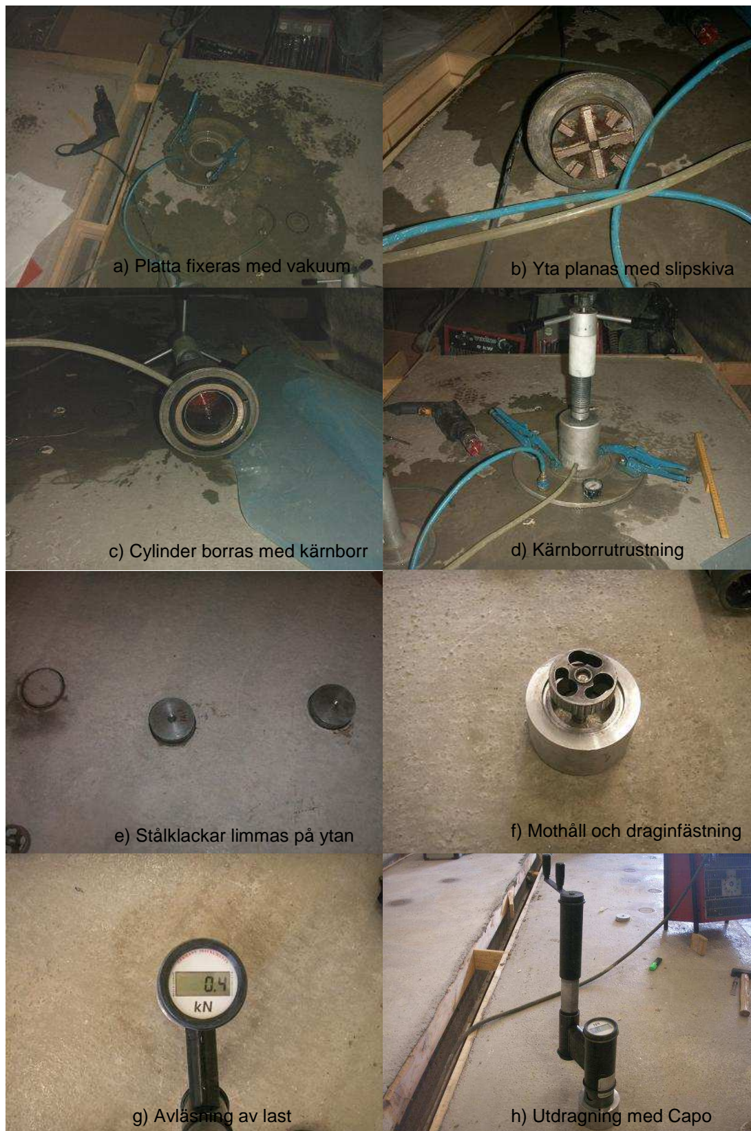
Figur 19 – Vidhäftningsprovning utfördes genom utdragning av cylindrar. I figuren visas de olika stegen: a) en platta fixeras med vakuum, b) ytan planas av, c och d) kärnbörning till ett djup på ca 60 mm (ca 10 mm i underlag), e) stålklackar fästs på cylindrars yta och f, g, h) utdragning med Capo-utrustning.
