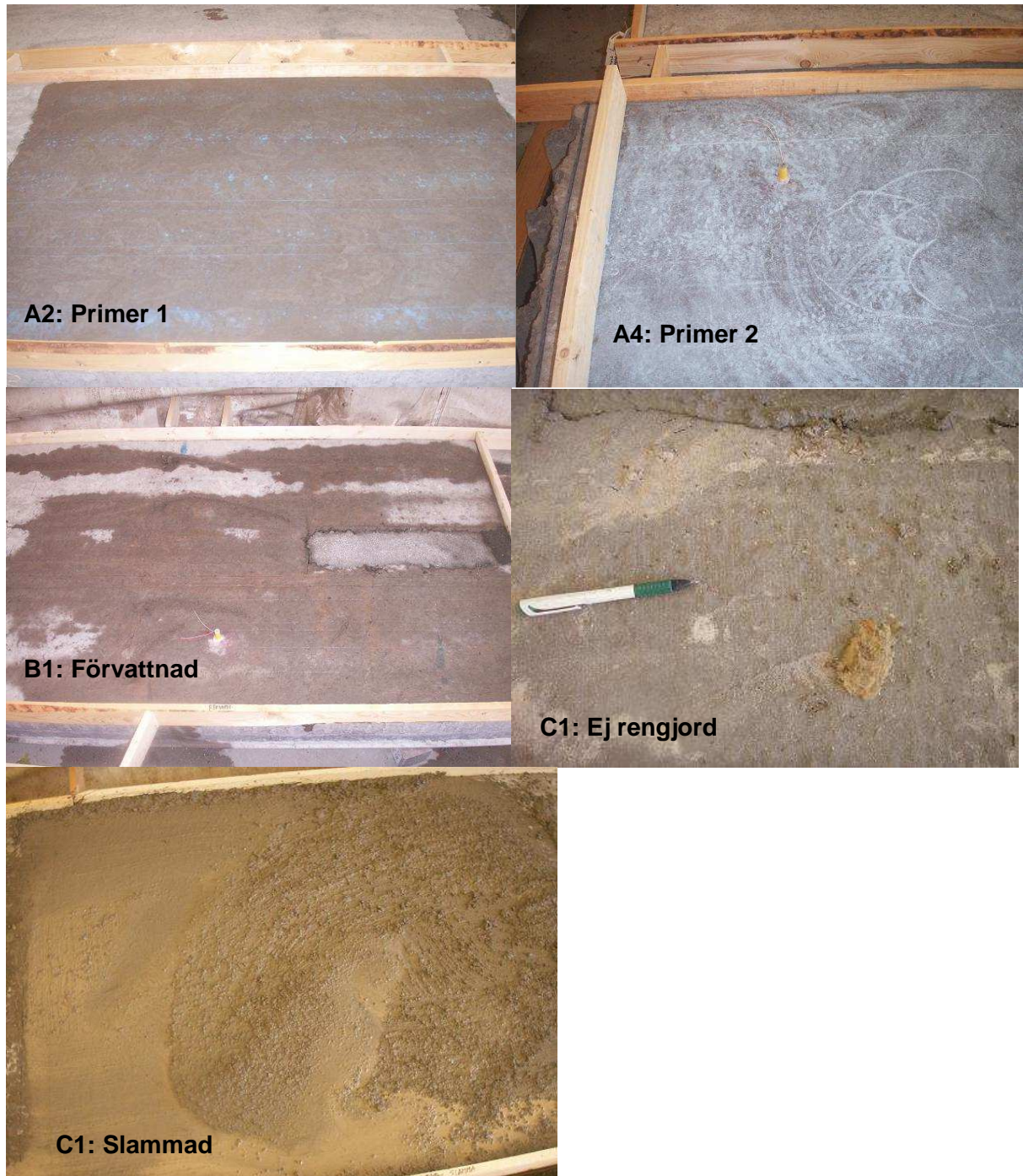
Figur 4 – Foton som visar hur ytan på några av de olika delytorna såg ut precis före pågjutning.
