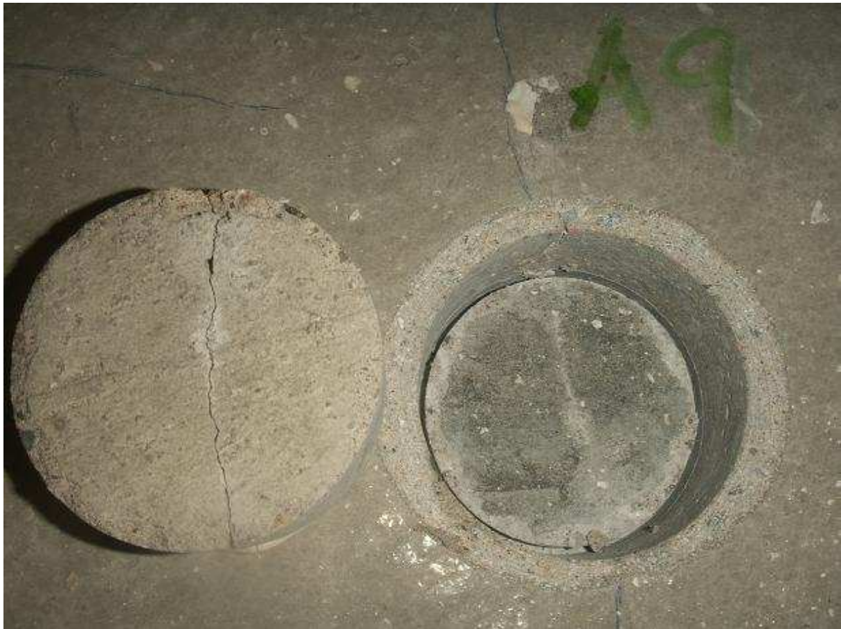
Figur 20 – Kärna från vidhäftningsprov nr A9 (se Figur 17) genom en av sprickorna i delytan med primer 1 på platta A.
