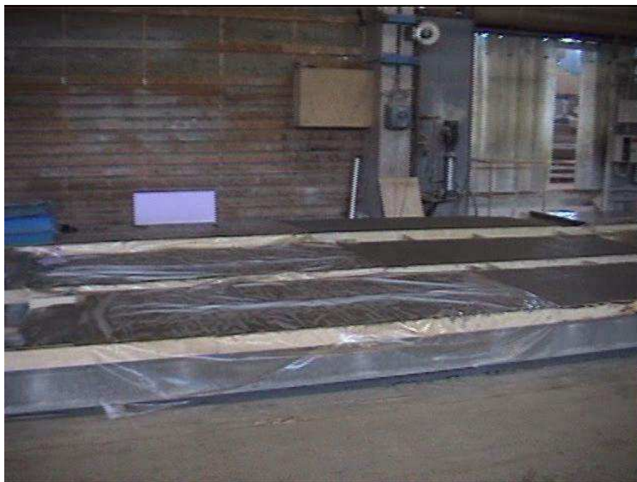
Figur 30 – Plastfolie utlagd över halva pågjutningen på varje platta (fält A och B).
